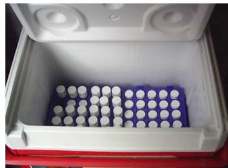
Foto 4. Tubos pasivo para monitoreo.
